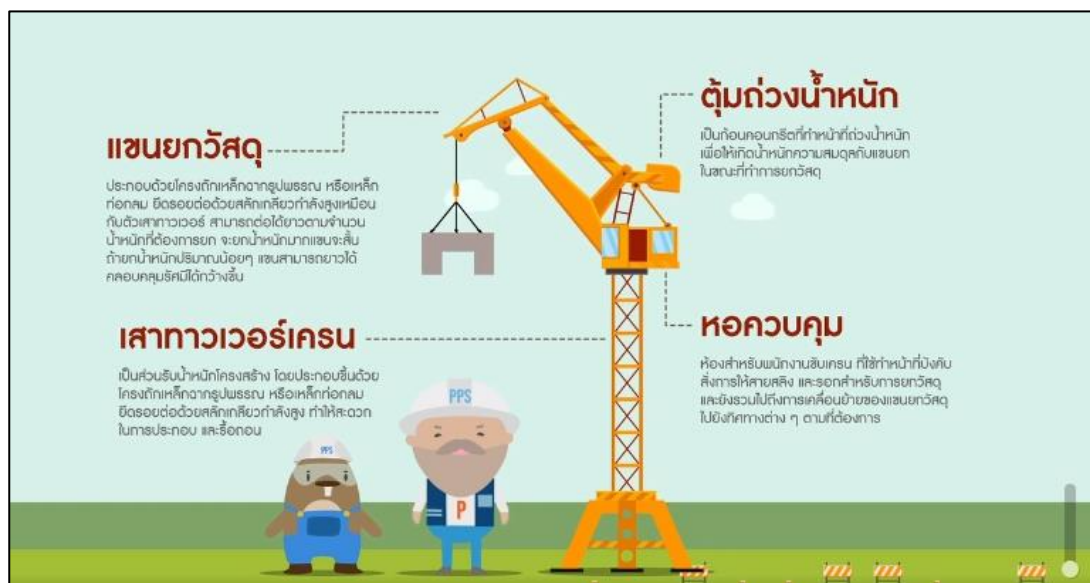
รูปที่ 2.13.3-5 ทาวเวอร์ เครน (Tower crane) แบบบูมกระดก (Luffing Jib Crane)
